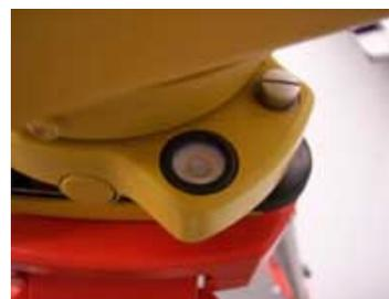
Nivel **tórico**, colocado sobre la alidada y que sirve para hacer una nivelación precisa del instrumento. Es un nivel de mucha precisión y suele llevar unas marcas separadas 2 mm. La burbuja debe quedar entre las marcas centrales, admitiéndose que durante un trabajo la burbuja pueda desplazarse hasta una división a derecha o izquierda.
