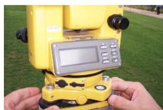
Colocamos el **nivel de la alidada** en dirección a dos tornillos, y girándolos en sentidos contrarios, centramos la burbuja, después giramos el aparato  $100^\circ$  y tocando el tercer tornillo, centramos la burbuja del nivel.
