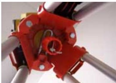
Todos los trípodes llevan colgada del elemento de unión una plomada que ha de coincidir con la señal marcada en el terreno.
