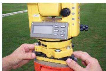
Comprobamos el centrado del instrumento con la plomada óptica, y si es necesario se afloja el tornillo de sujeción del aparato al trípode, desplazando suavemente el instrumento, o con los tornillos nivelantes centramos la señal con la marca y subiendo o bajando las patas del trípode se centra la burbuja del nivel esférico.
