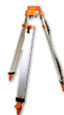
La cabeza del trípode es una plataforma circular o triangular, sobre la que se coloca el instrumento. Esta plataforma tiene un gran orificio en el centro por la que pasa el elemento de unión (tornillo), que se puede desplazar, permitiendo ocupar al instrumento varias posiciones.
