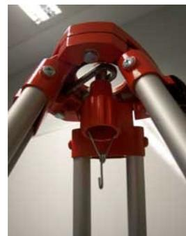
Para la unión, el tornillo enrosca en una placa de acero que hace muelle y va unida a las patas del instrumento, consiguiéndose la sujeción al comprimirlas contra la meseta por la presión del tornillo.
